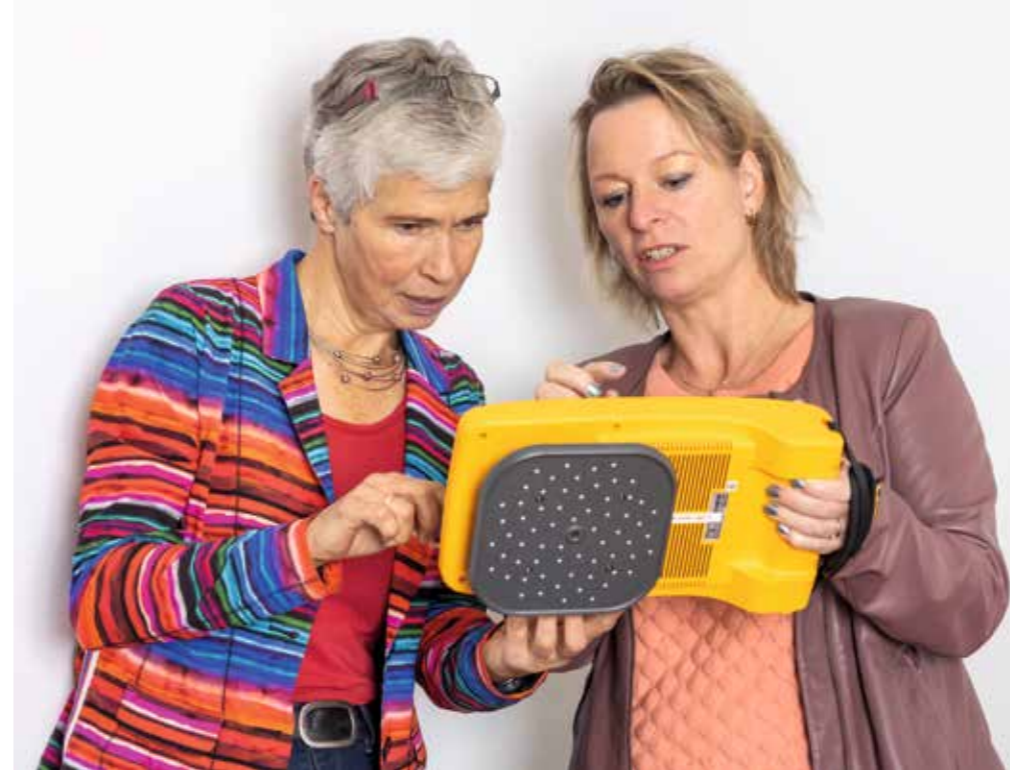
Een geluidscamera is een hulpmiddel om het geluidsveld van een ruimte zichtbaar te maken.
